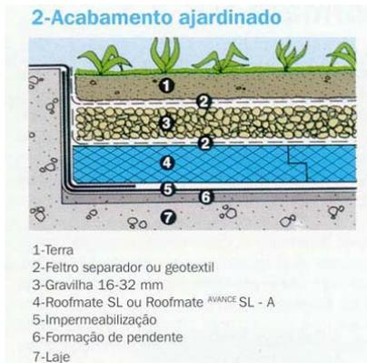
Figura 9 – Camada de terra vegetal sobre camada de gravilha
