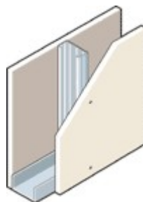
Figura 9 – Aplicação de placas de gesso cartonado
