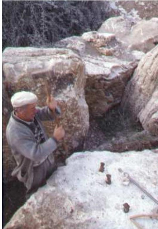
**Figura 12 - Fraccionamento de blocos através da introdução de cunhas <sup>a</sup>**
