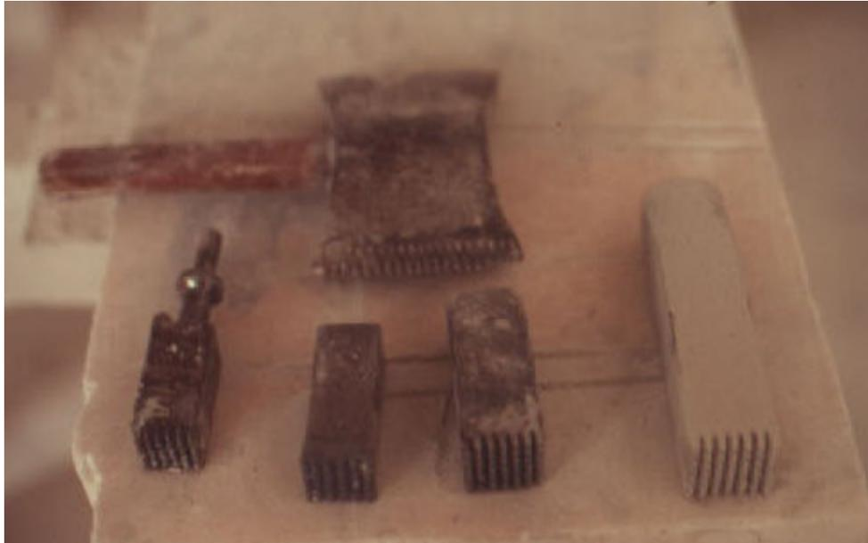
**Figura 17 - Na primeira fila: conjunto de 4 pontas de bujarda, permitindo pela ordem da esquerda para a direita, um efeito de bujarda mais fina para um mais grosso; atrás: escoda <sup>a</sup>.**
