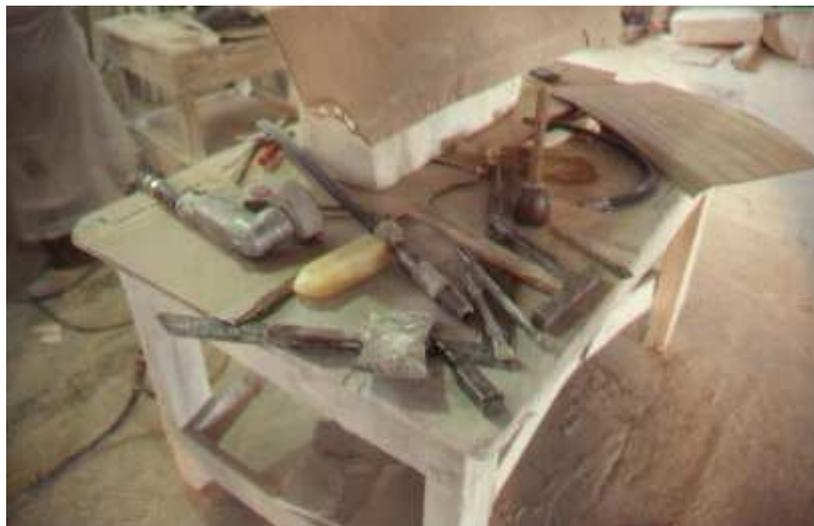
**Figura 20 - Utensílios semi-manuais para o trabalho de acabamento da pedra: bujardas manuais e semi-manuais, maceta, maço, compasso, riscador, pentes, esquadro, escopro pneumático, escoda, rebarbadora <sup>a</sup>.**
