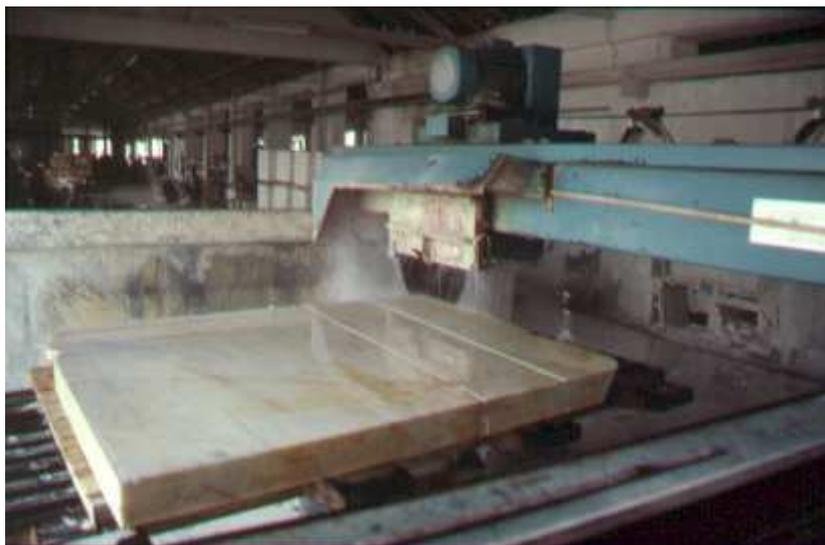
**Figura 14 - Lavra mecânica de pedra: máquina de corte computadorizada (várias placas podem ser simultaneamente cortadas; o corte é processado de forma a aproveitar a maior área possível de pedra)<sup>a</sup>.**
