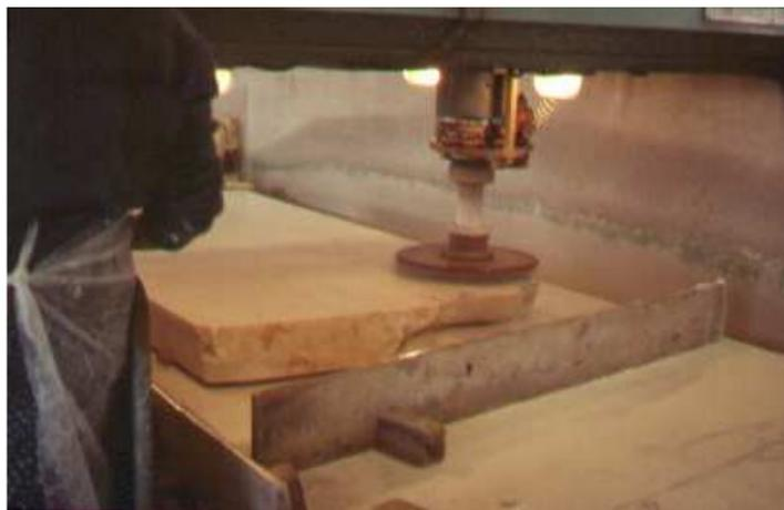
Figura 21 - Lavra mecânica – pormenor de disco de abrasão para polimento<sup>a</sup>.
