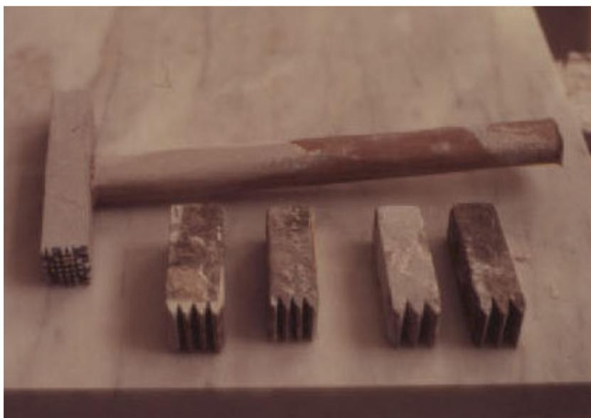
**Figura 18 - Na primeira fila: conjunto de 4 pontas para martelo de bujardar (mecânico), que permite obter um acabamento tipo penteado de dentes (mais fino ou mais grosso em função do tipo de dentes); atrás: um martelo de bujardar tradicional <sup>a</sup>.**
