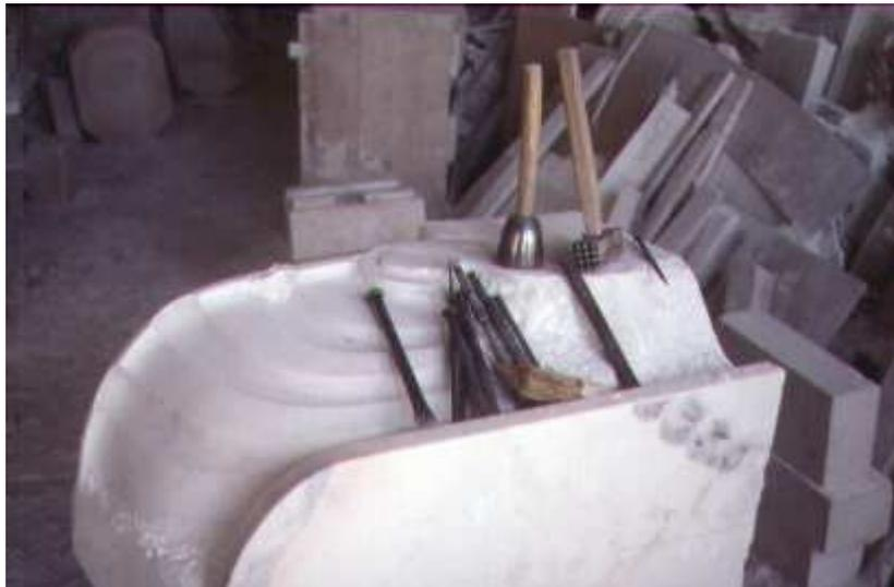
**Figura 19- Utensílios manuais para o trabalho de acabamento da pedra <sup>a</sup>.**
