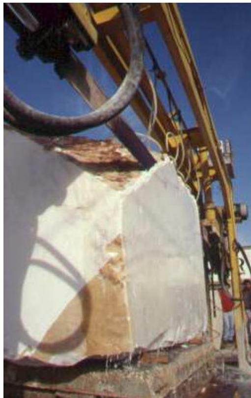
**Figura 13 - Corte de uma placa a partir de um bloco de pedra<sup>a</sup>**
