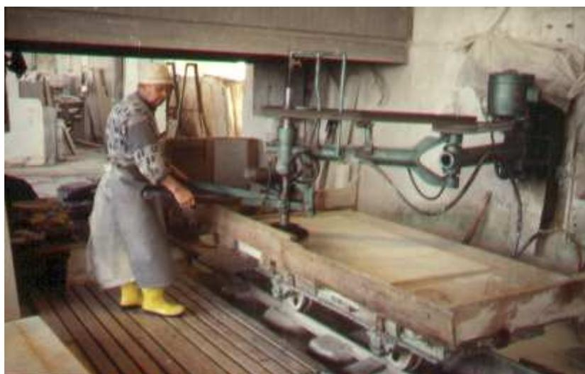
**Figura 15 - Lavra mecânica - disco de abrasão para polimento<sup>a</sup>.**
