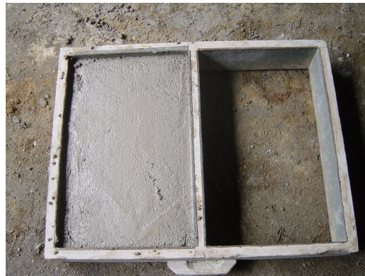
Figura 8 – Molde de madeira utilizado na produção de adobe 1 .
